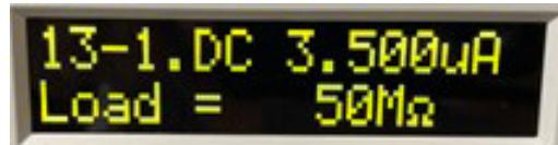
按下前面板的測試按鈕。測試器將在輸出連接器上提供約175Vdc，螢幕將顯示：
