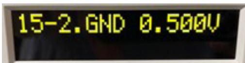
按下前面板的測試按鈕。測試器將在輸出連接器上提供約0.5Vac，螢幕將顯示：
