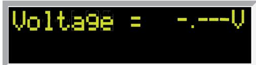
旋轉並按下飛梭旋鈕，將標準交流電壓表的讀數輸入測試器。輸入所有數字後，測試器將前進至下一個校正點。
