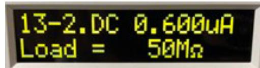
按下前面板的測試按鈕。測試器將在輸出連接器上提供約30Vdc，螢幕將顯示：
