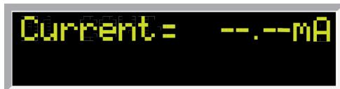
旋轉並按下飛梭旋鈕，將標準交流電流表的讀數輸入測試器。輸入所有數字後，測試器將前進至下一個校正點。
