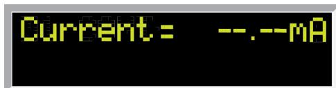
旋轉並按下飛梭旋鈕，將標準直流電流表的讀數輸入測試器。輸入所有數字後，測試器將前進至下一個校正點。
