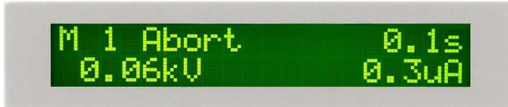
假如測試正在進行之中，而按“RESET”開關或使用遙控裝置中斷測試時，其中斷測試的時間在本儀器讀到第一筆測試結果之前，液晶顯示器會顯示：
