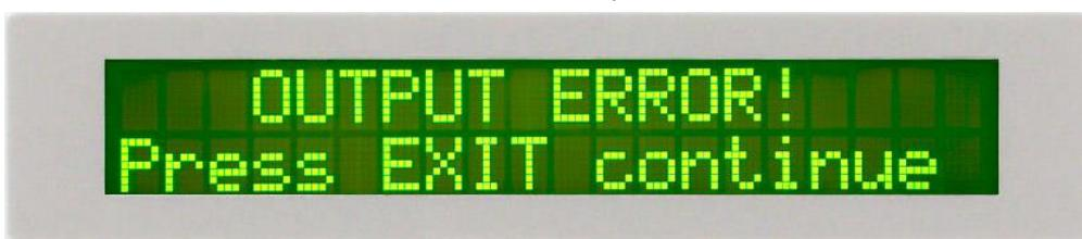
此時按“RESET”鍵是無效的，須按“EXIT”鍵方可解除該狀況。當“EXIT”鍵被按下，本儀器會繼續正常的失敗狀態，須按“RESET”方能將失敗的指示燈和蜂鳴器叫聲清除。在跳出輸出錯誤訊息顯示，液晶顯示器會顯示：
