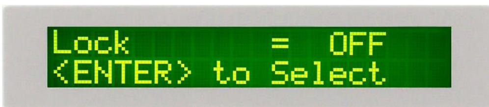
請用 ENTER 輸入鍵選擇鎖定 (ON) 或未鎖定 (OFF)，然後按 EXIT 鍵。程序將切換按鍵鎖定功能並自動將程序推進到操作模式。如果按鍵鎖定功能處於鎖定模式，前面板上的 LOCK 指示燈將亮起。
