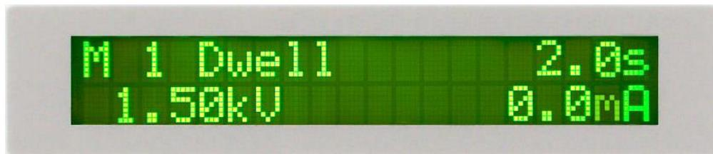
交流耐壓測試的緩升測試時間非常短，而在本儀器讀到第一筆測試結果之前，液晶顯示器會顯示：
