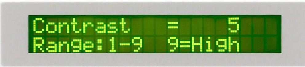
請用數字鍵輸入 LCD 反襯亮度的數字為 1 - 9，然後再按“ENTER”鍵，顯示器會立即改變 LCD 的反襯亮度，以供立即檢視反襯亮度是否適當。如須修改反襯亮度，可以直接修改，再按“ENTER”鍵進行檢視。
