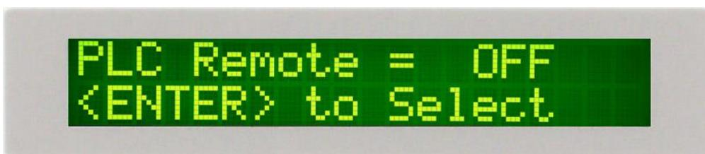
請用“ENTER”鍵選擇 PLC 遙控的模式為 ON 或 OFF。假如 PLC 遙控設定為“ON”，本儀器的測試啟動功能必須經由儀器背板的遙控端子控制，面板上的“TEST”開關不會起作用，而“RESET”開關仍然維持可以操作，不受任何影響。假如 PLC 遙控設定為“OFF”，本儀器的
