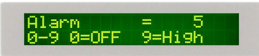
警報音量的設定為 0 - 9，0 是作為關閉警報聲音之用，1 的音量最小，而 9 為最大。請用數字鍵輸入警報音量的數字，然後再按“ENTER”鍵，程式會立即改變警報音量的設定，並發出樣品音量，以供立即檢查警報音量是否適當。如須修改警報音量，可以直接修改，再按“ENTER”鍵進行檢查。
