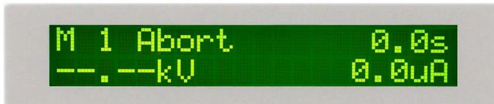
在交流耐壓測試開始時，當電壓在緩升時間時但在獲取儀表讀數之前，液晶顯示器會顯示：
