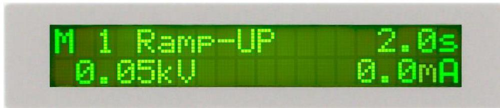
在交流耐壓測試期間，當測試時間更新時，液晶顯示器會顯示：
