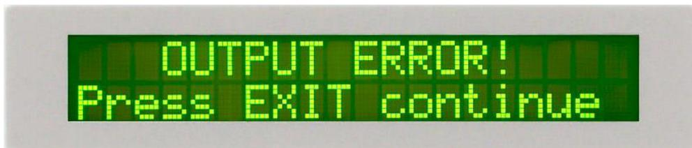
此時按“RESET”鍵是無效的，須按“EXIT”鍵方可解除該狀況。當“EXIT”鍵被按下，本儀器會繼續正常的失敗狀態，須按“RESET”方能將失敗的指示燈和蜂鳴器叫聲清除。在跳出輸出錯誤訊息顯示，液晶顯示器會顯示：
