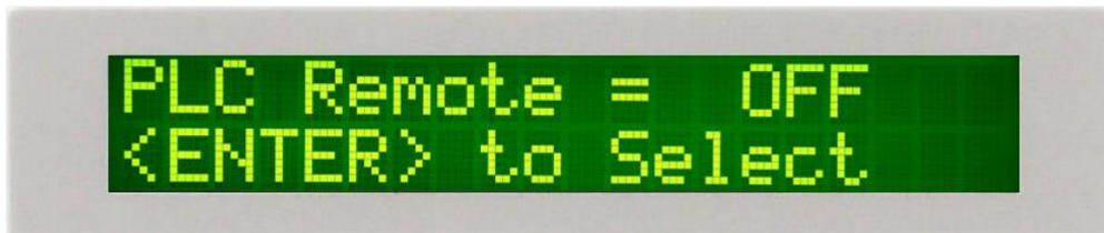
請用“ENTER”鍵選擇 PLC 遙控的模式為 ON 或 OFF。假如 PLC 遙控設定為“ON”，本儀器的測試啟動功能必須經由儀器背板的遙控端子控制，面板上的“TEST”開關不會起作用，而“RESET”開關仍然維持可以操作，不受任何影響。假如 PLC 遙控設定為“OFF”，本儀器的
