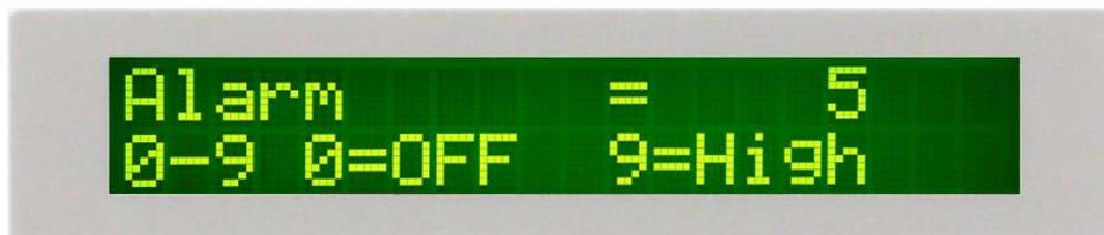
警報音量的設定為 0 - 9，0 是作為關閉警報聲音之用，1 的音量最小，而 9 為最大。請用數字鍵輸入警報音量的數字，然後再按“ENTER”鍵，程式會立即改變警報音量的設定，並發出樣品音量，以供立即檢查警報音量是否適當。如須修改警報音量，可以直接修改，再按“ENTER”鍵進行檢查。
