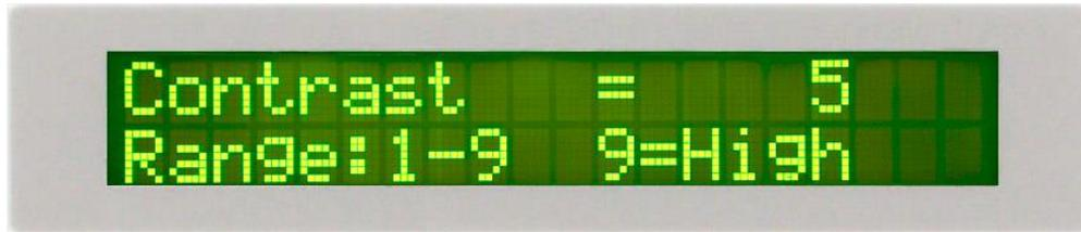
請用數字鍵輸入 LCD 反襯亮度的數字為 1 - 9，然後再按“ENTER”鍵，顯示器會立即改變 LCD 的反襯亮度，以供立即檢視反襯亮度是否適當。如須修改反襯亮度，可以直接修改，再按“ENTER”鍵進行檢視。
