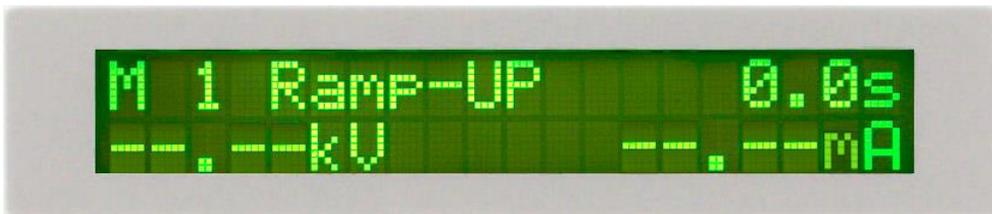
在交流耐壓測試期間，當電壓在緩升時間時，液晶顯示器會顯示：
